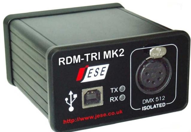
Das USB-RDM TRI wird mit der GET/SET MV Controller Software gebündelt ausgeliefert. Da das Interface so wohl DMX empfangen als auch DMX senden kann, kann es einfach in eine DMX Leitung eingeschleift werden. Jede vorhandene DMX Steuerung -z.B. Ihr vorhandenes Lichtsteuerpult- kann so einfachst um volle RDM Funktionalität erweitert werden. Einfacher geht es nun wirklich nicht!
